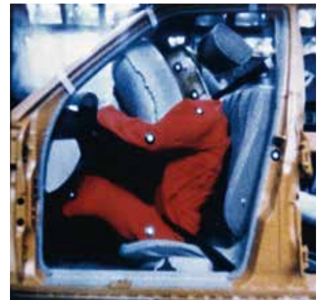
1979-1984: Phasenfoto der Funktionsweise von Lenkrad-Airbag und Gurtstraffer, 1981. Zu dieser Zeit bietet Daimler-Benz weltweit als einziger Hersteller den Gurtstraffer für den Beifahrer und den Airbag für den Fahrer an. Foto: © Daimler AG
